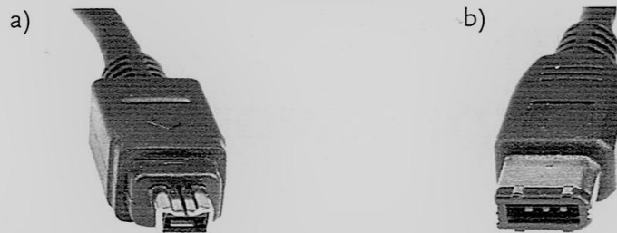
Rys. 67.2. Wtyczki kabla FireWire: a) 4-stykowe, b) 6-stykowe
